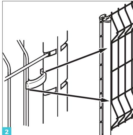
2 Mettre les fils du panneau dans les gorges du poteau. Positionner des bloqueurs **AXOR®** afin de faciliter le positionnement et la tension des panneaux entre les poteaux pendant la prise du béton. Le bloqueur universel **DIRICKX** est aussi compatible.
